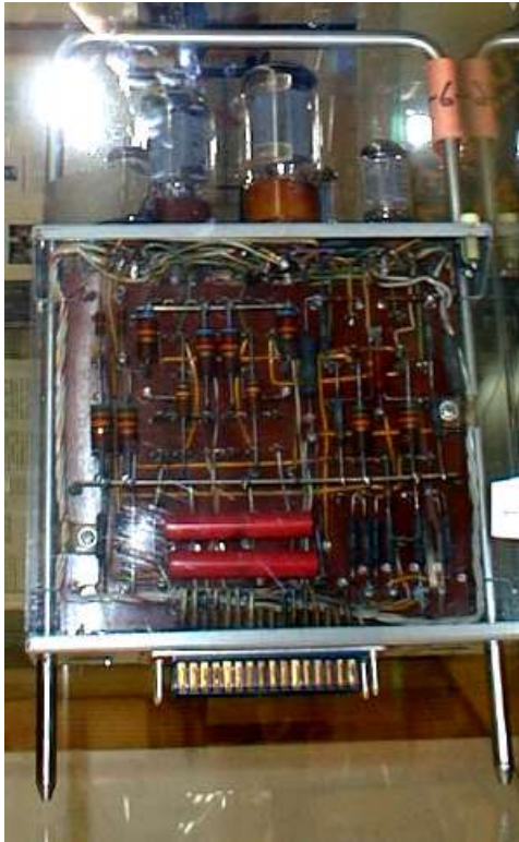
Unità di memoria da 1 bit (flip-flop) a valvole
